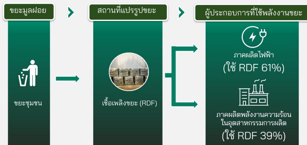
รูปที่ 1 ห่วงโซ่อุปทานพลังงานจากเชื้อเพลิงขยะ RDF
